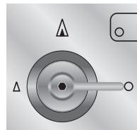
В моделях с предохранительными клапанами для розжига придержите ручку нажатой несколько секунд, чтобы позволить термопаре разогреться. Может случиться так, что в момент отпуска ручки конфорка погаснет: это означает, что термопара недостаточно нагрелась.
