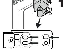
13. Снова прикрутите шарнирный уголок с противоположной стороны. Закрутите 3 винта в обозначенные отверстия.
