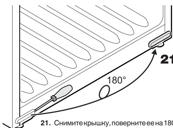
21. Снимите крышку, поверните ее на 180° и снова вставьте на противоположной стороне.
