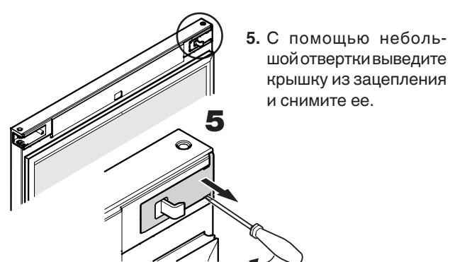
5. С помощью небольшой отвертки выведите крышку из зацепления и снимите ее.
