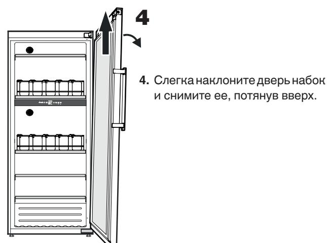
4. Слегка наклоните дверь набок и снимите ее, потянув вверх.
