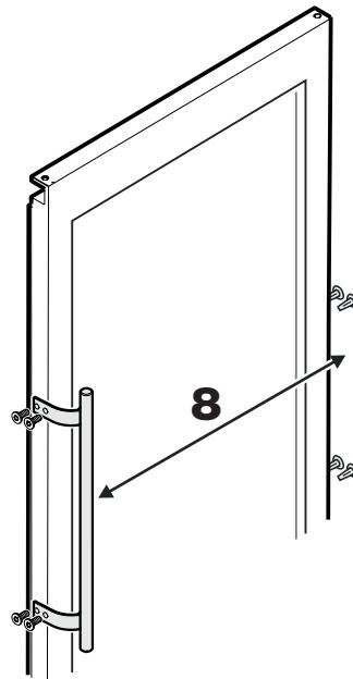
8. Переставьте ручку и пробки на противоположную сторону.
