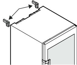
Вставьте распорки с тыльной стороны прибора в верхней части справа и слева.
