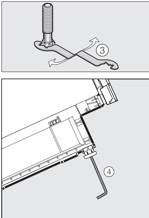
Вы можете выворачивать ножки или с помощью прилагаемого гаечного ключа ③, или с помощью торцового шестигранного ключа ④.
