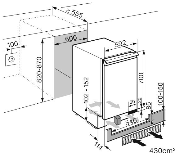
Перед встраиванием обратите внимание на то, чтобы ниша для встраивания точно соответствовала заданным размерам. Обязательно соблюдайте заданные размеры вентиляционных отверстий. Вырез в цокольной панели для прилагаемой вентиляционной решетки должен быть отцентрирован с прибором, чтобы обеспечить правильную работу прибора.
