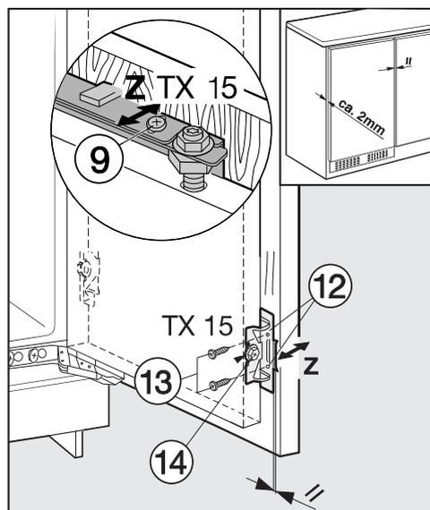
■ Предварительно просверлите в мебельной дверце монтажные отверстия ⑫ и вкрутите шурупы ⑬. Обратите внимание на правильное расположение металлических кантов (символ //).
