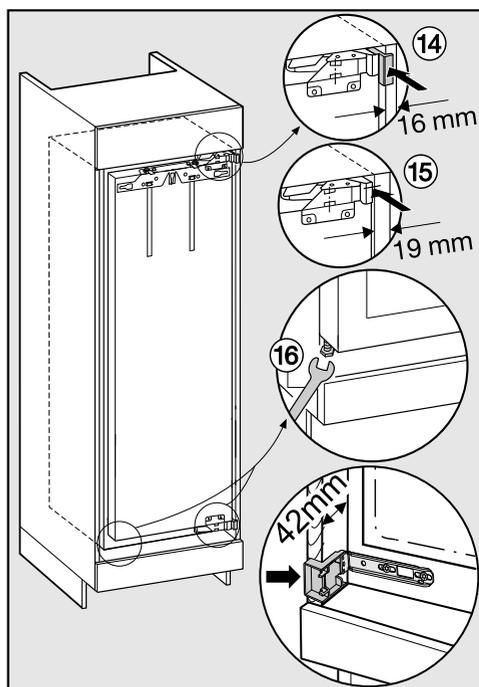
■ Задвиньте прибор в нишу до тех пор, пока все крепежные уголки не прижмутся к переднему краю боковой стенки шкафа.
