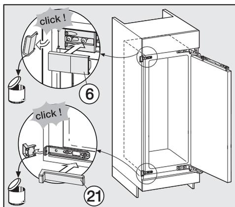
■ Придвиньте неплотно сидящие крепежные уголки к стенке шкафа.
