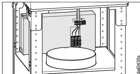
Для надёжного подключения следует использовать имеющийся фиксатор кабеля.
