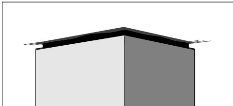
Между коробом вытяжки и потолком можно смонтировать **промежуточную рамку**. Она может использоваться, если необходимо создать оптический эффект промежутка между потолком и коробом (полоска тени). Это может потребоваться, например, если потолок негоризонтальный или неровный. Вытяжка выравнивается в вертикальном положении с помощью прилагаемых выравнивающих деталей. Оптические дефекты между коробом и потолком будут замаскированы полоской тени.
