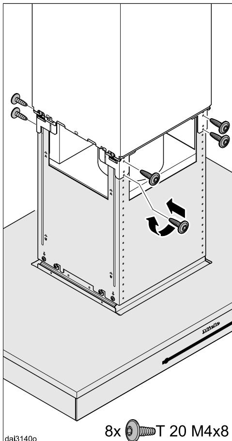
■ Поднимите корпус вытяжки на желаемую высоту и туда его приверните.
