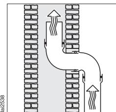
Если вытяжной канал отводится в вентиляционную трубу, то входной штуцер должен быть направлен в сторону потока воздуха.
