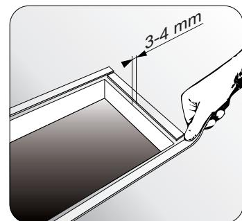
Выполнив эти операции, положите варочную панель на изолирующую прокладку и с помощью винтов и крепежных скоб прикрепите панель к опорной конструкции, обеспечив идеальную плоскость.
