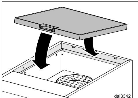
■ Вставьте угольный фильтр в гнездо с верхней стороны вытяжки.
