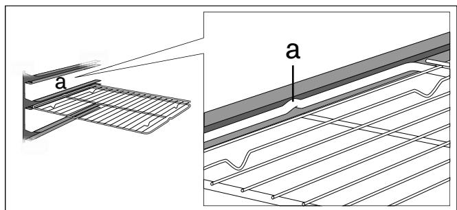
При установке неперфорированной емкости следите за тем, чтобы выемка (a) была обращена вбок.
