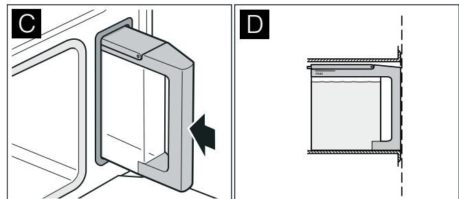
Бак должен быть установлен заподлицо с нишой для бака (рис. D).
