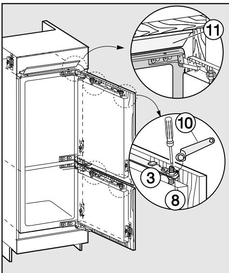
■ Тую затяните гайки ③ на дверцах прибора с помощью гаечного ключа ⑩, удерживая при этом отверткой регулировочные стержни ⑧.
