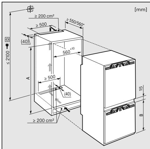
\* Заявленное потребление электроэнергии рассчитано для глубины ниши 560 мм. В нише глубиной 550 мм прибор будет полностью работоспособен, однако, у него будет немногое более высокое энергопотребление.
