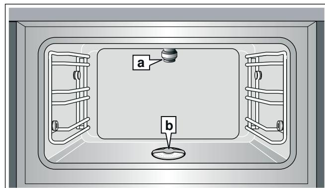
С помощью программы очистки удаляются стойкие загрязнения. Картридж для очистки (а) привинчивается в верхней части рабочей камеры. Рабочая камера очищается, промывается и просушивается автоматически. Сетчатый фильтр (б) во время выполнения программы очистки должен оставаться установленным на дне рабочей камеры.
